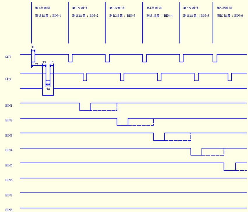
注意：所有信号均为低电平有效！电平：TTL电平
